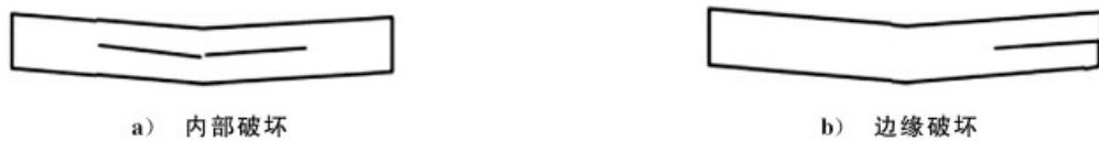
图 G.3 试样层间剪切破坏模式示意图
